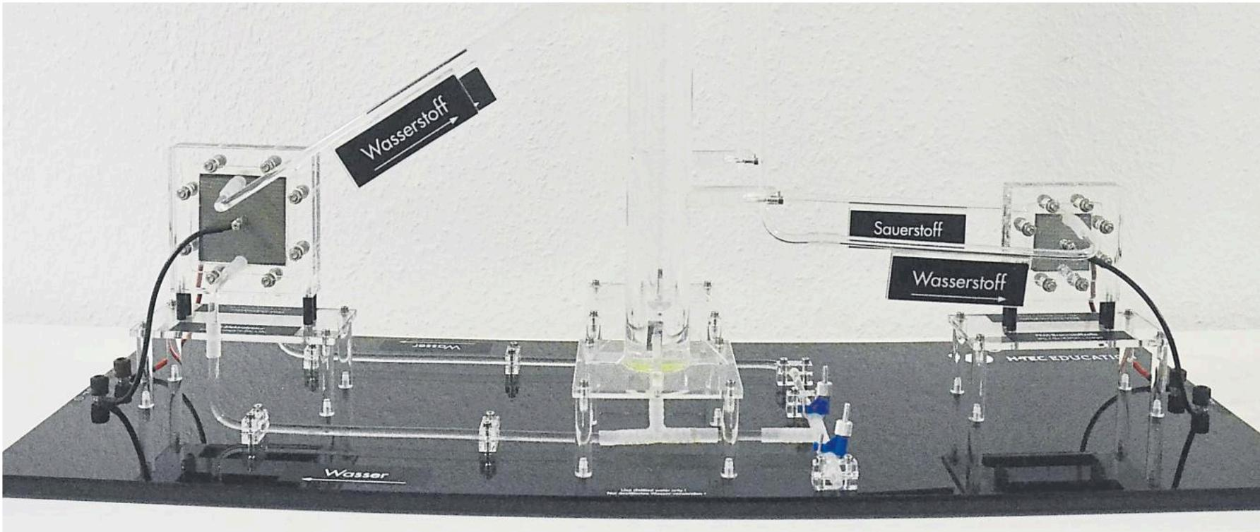
Modell einer Elektrolyseanlage.
